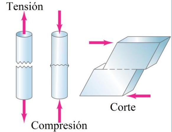
Los puntos de ruptura de los materiales bajo tensión, compresión y corte se han determinado experimentalmente.
